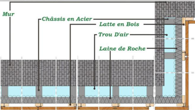
Le Profil Omega peut être utilisé pour installer des panneaux sur le mur. Cinq différentes options disponibles. Il est également possible d'utiliser ce système dans l'installation de panneaux de plafond.
